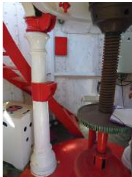
3- Vue le mécanisme de rotation de la lentille de Fresnel
